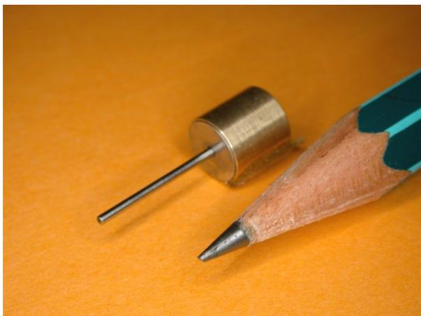
Der realisierte Generator mit den Außenabmessungen 12 mm Durchmesser, 3 mm Länge liefert bei einer Drehzahl von 10000 U/min eine Wechselspannungsamplitude von 5 V und eine Leistung von 0,4 W.
