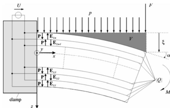
Am Institut für Elektromechanische Konstruktionen der TU Darmstadt wurden die theoretischen Grundlagen zur Beschreibung des statischen und dynamischen Verhaltens einseitig eingespannter piezoelektrischer n-Schicht-Biegeaktoren erarbeitet und in analytisch geschlossener Form abgeleitet. Damit lässt sich das dynamische Verhalten piezoelektrischer Multilayer-Biegeaktoren beschreiben und schaltungs-
