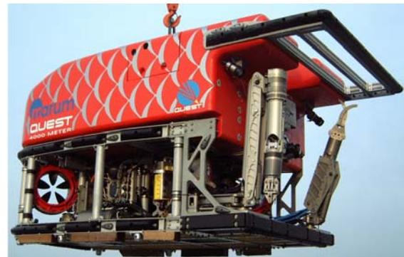
**ROVs** (Remotely Operated Vehicles) werden von einem Mutterschiff durch lange Kabel mit Energie versorgt und über ein Glasfaserkabel gesteuert. Ihr Einsatz ist infolge ihres Aufbaus sowie dem erforderlichen Mutterschiff kostenintensiv. Die Versorgungskabel verhindern das Vordringen in tiefere Meeresbereiche, da die Kabel sehr dick und schwer sind. Außerdem treten durch die Länge der Kabel große elektrische Verluste auf.
