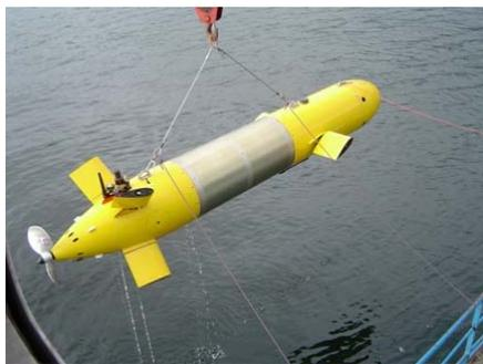
**AUVs** (Autonomous Underwater Vehicles) sind Robotersysteme, die über mindestens ein Antriebssystem verfügen, in drei Raumrichtungen manövrieren und eine integrierte Energieversorgung aufweisen. Mit Hilfe von Sensoren erfüllen AUVs eigenständig vorprogrammierte Missionen. Die elektronischen und mechanischen Komponenten sind meist in einer Druckhülle integriert.
