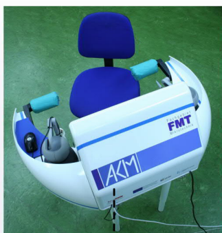
Bedienkonsole mit Eingabegeräten und Steuerelektronik
