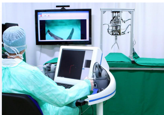
Bedienkonsole mit Eingabegeräten und Steuerelektronik
