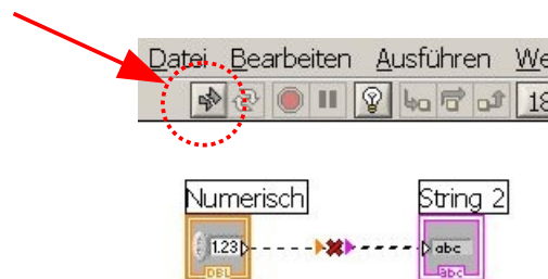
Abb. 10-3 Fehlerhafte Syntax: hier wurde eine numerische Eingabe mit einer String-Anzeige verbunden. Die gebrochene Verbindung und der gebrochene Pfeil deuten einen Fehler an
